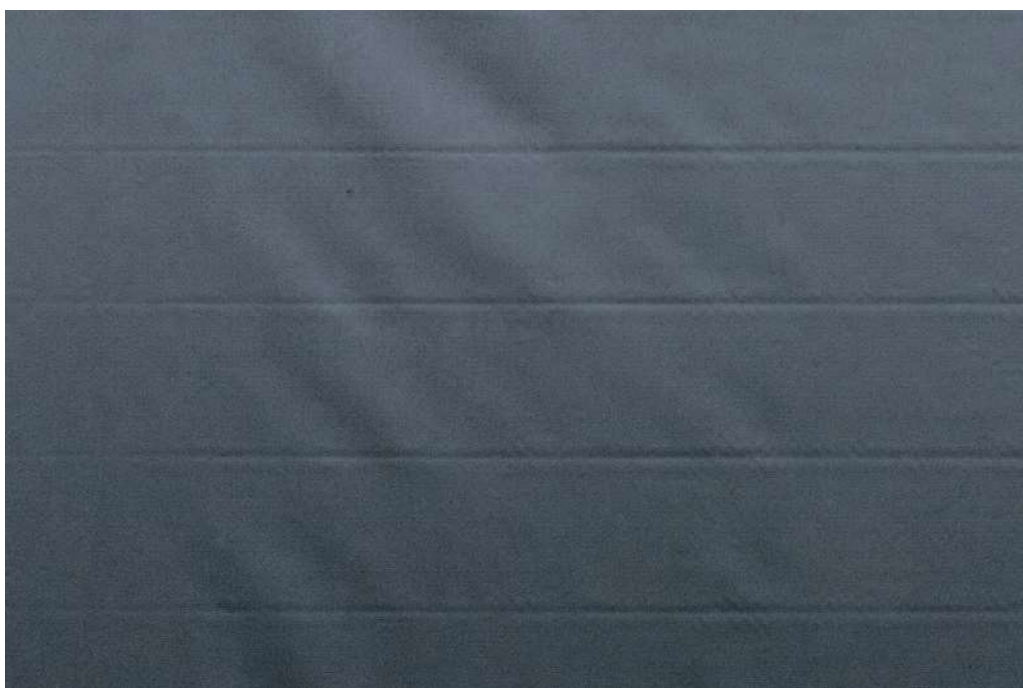
Bild 9.4.3 Mögliche zulässige Verformung in der Tuchfläche bei ZIP-Anlagen
