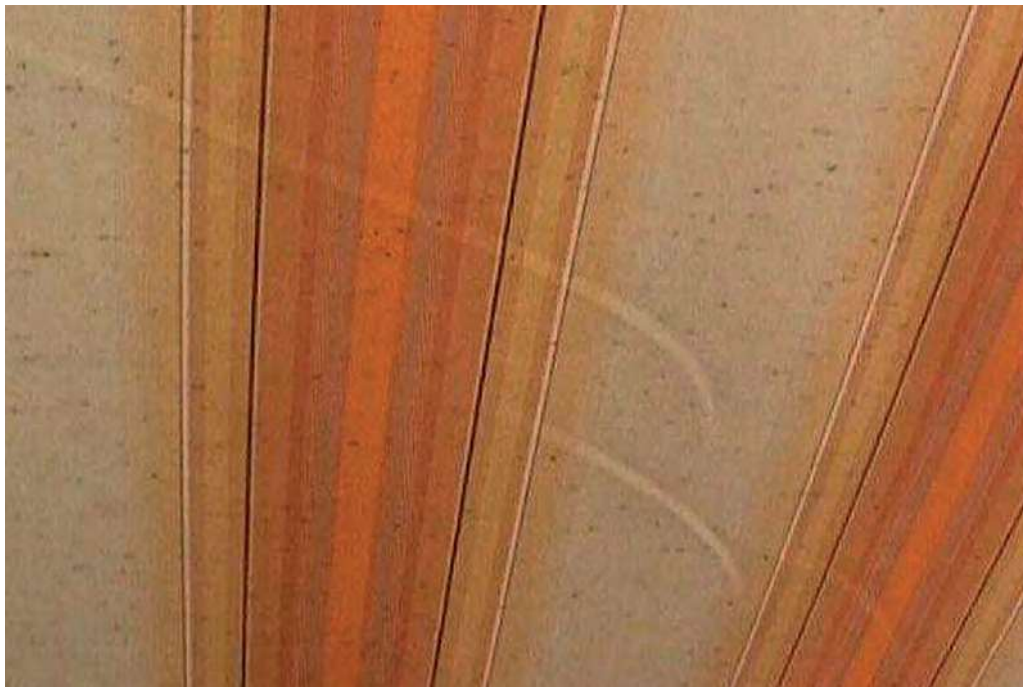
Bild 9.1.13 Darstellung von Überlagerung von Wickelfalten
