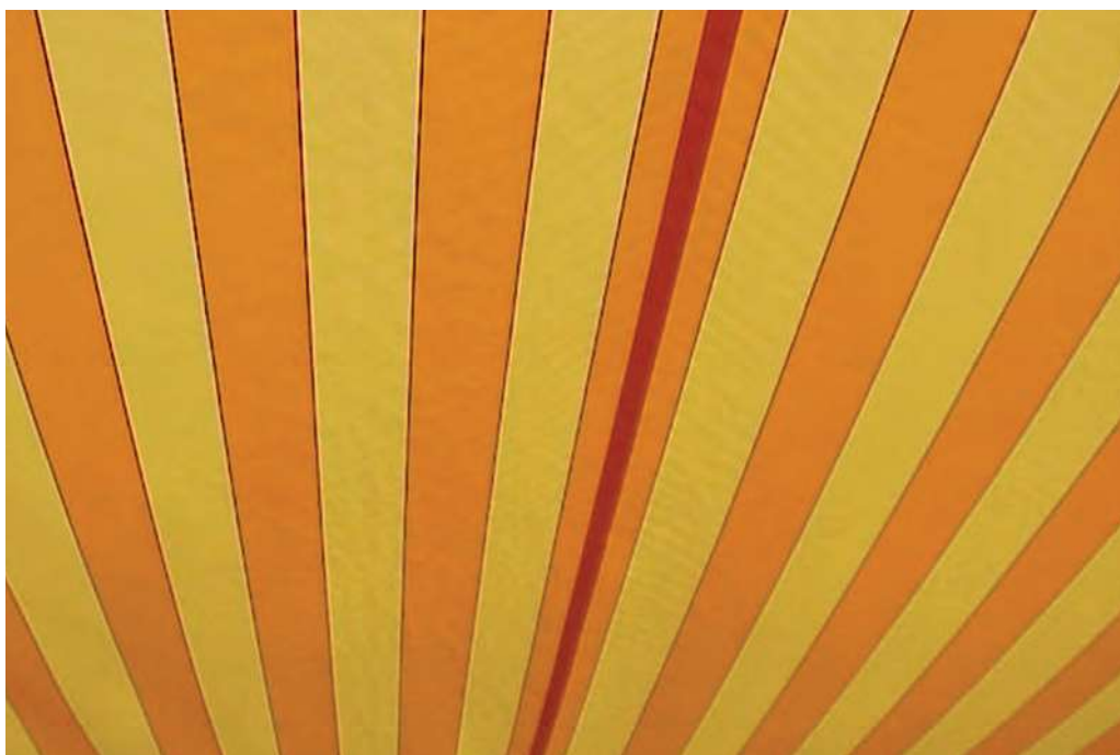
Bild 9.1.8 Zulässige Welligkeit im Nahtbereich (Wabenbildung)
